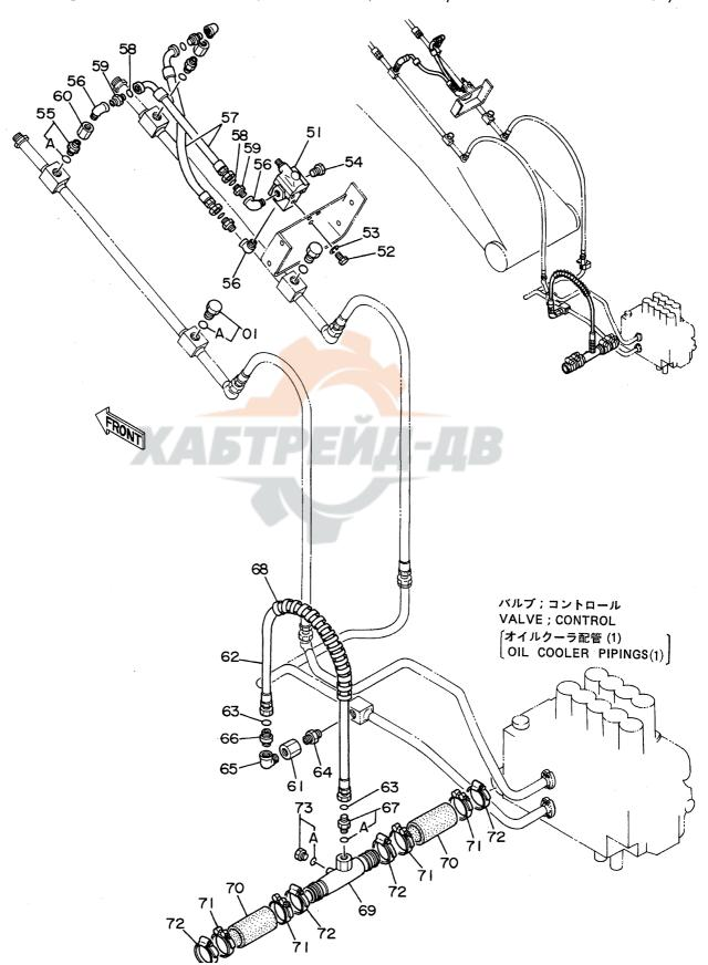
プ<sup>™</sup>レーカ・クラヴシヤ ヨウ ハイカン (3) <オカダ<sup>™</sup>ノフルカワ フ<sup>™</sup>レーカ〉 PIPINGS (3) FOR BREAKER・CRUSHER < OKADA / FURUKAWA BREAKER>
