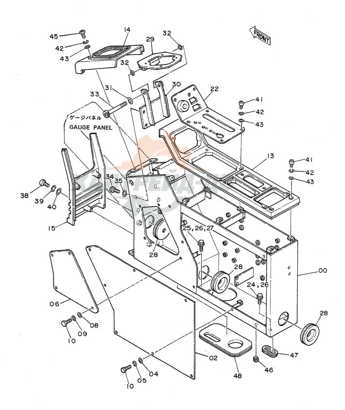
コントロールホックス (ミキッ) 〈SDX〉 CONTROL BOX (R) 〈SDX〉
