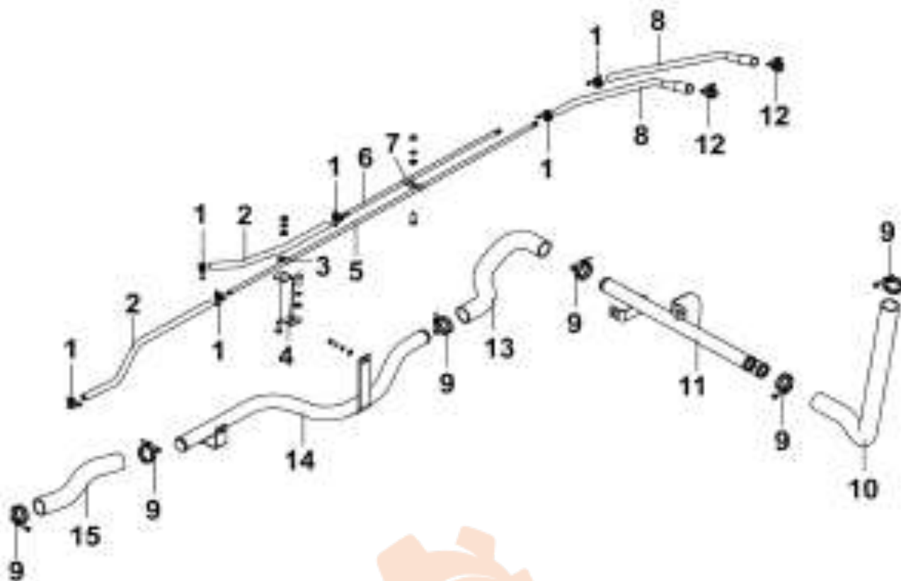
Рис.90. Трубопроводы системы охлаждения
